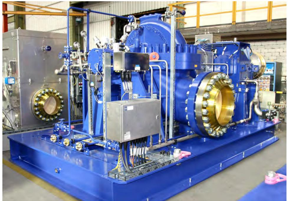
As duas bombas- do tipo ZLM I 530/08 – com uma vazão de 5,600 m<sup>3</sup>/hr e uma altura manométrica de 505 metros e uma potência nominal de 7.7 Megawatt. Essas bombas foram testadas com sucesso na planta da Alemanha e já foram entregues ao cliente. A previsão é de que as bombas sejam instaladas até o fim deste ano e colocadas em operação em Março de 2014.
