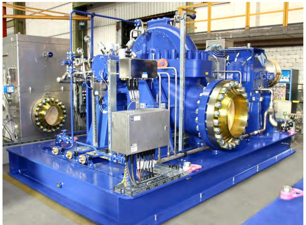
Cada una de las bombas tipo ZLM I 530/08, tiene un flujo de 5,600 m<sup>3</sup>/hr (24,656 GPM) con una carga de 505mts (1657 ft) y una potencia de 7.7 MW (10,326 HP). Estas bombas fueron probadas satisfactoriamente en la planta de Alemania y ya fueron entregadas al cliente. Se espera que sean instaladas a final de este año para iniciar operaciones en Marzo de 2014.
