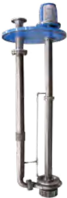
La VSP es una bomba de sumidero con impulsor semi-abierto, diseñado para agua potable, y la VSP Anti-Atasco es una bomba de sumidero que maneja sólidos mediante un impulsor cerrado, diseñado para manejar agua con sólidos de hasta 4" de diámetro. Construcción estándar en hierro fundido para ambos tipos.
